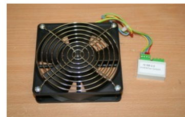
Ventilator – Reinigung mit einem weichen, feuchten Tuch
